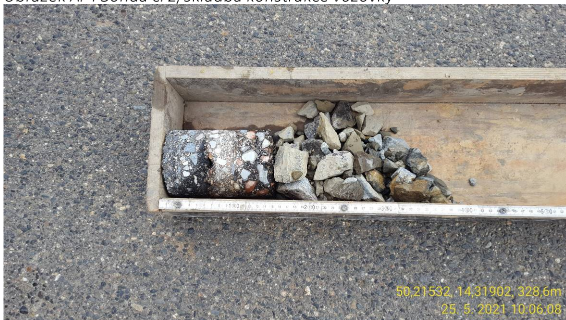
Obrázek A. 4 Sonda č. 2, skladba konstrukce vozovky
