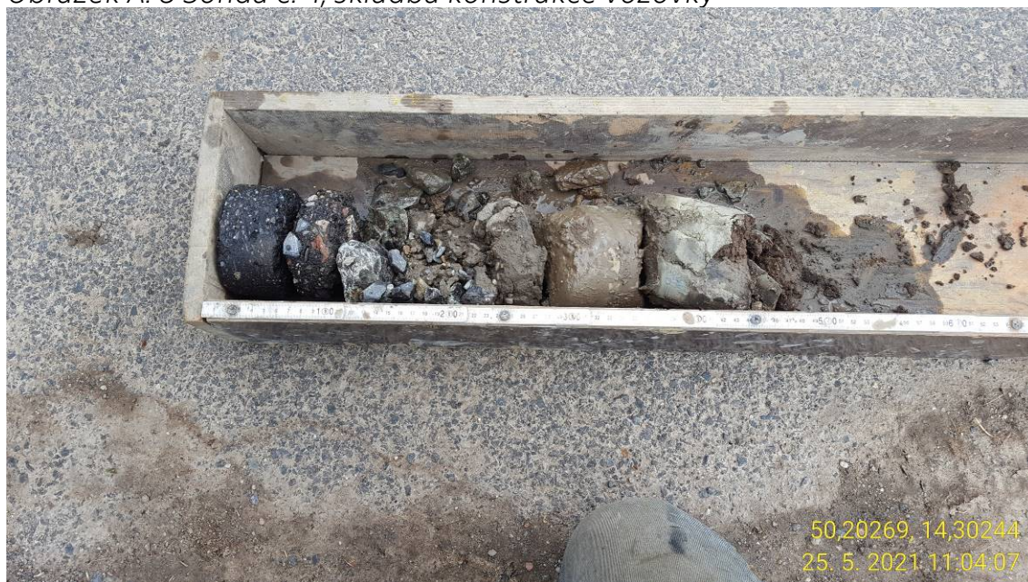
Obrázek A. 8 Sonda č. 4, skladba konstrukce vozovky
