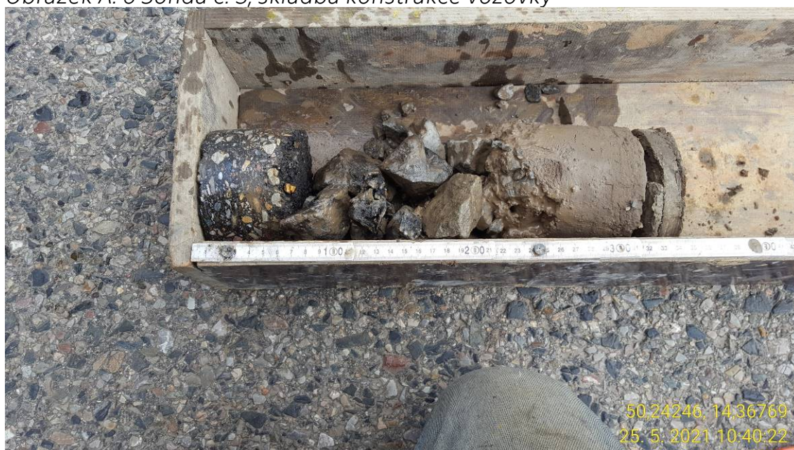
Obrázek A. 6 Sonda č. 3, skladba konstrukce vozovky
