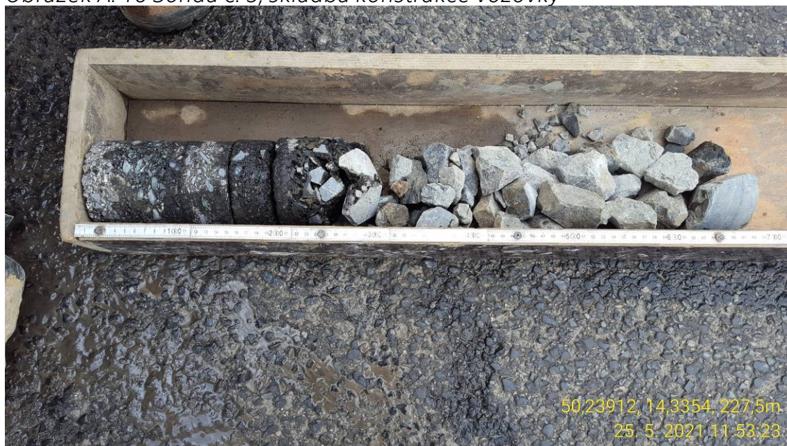
Obrázek A. 10 Sonda č. 5, skladba konstrukce vozovky
