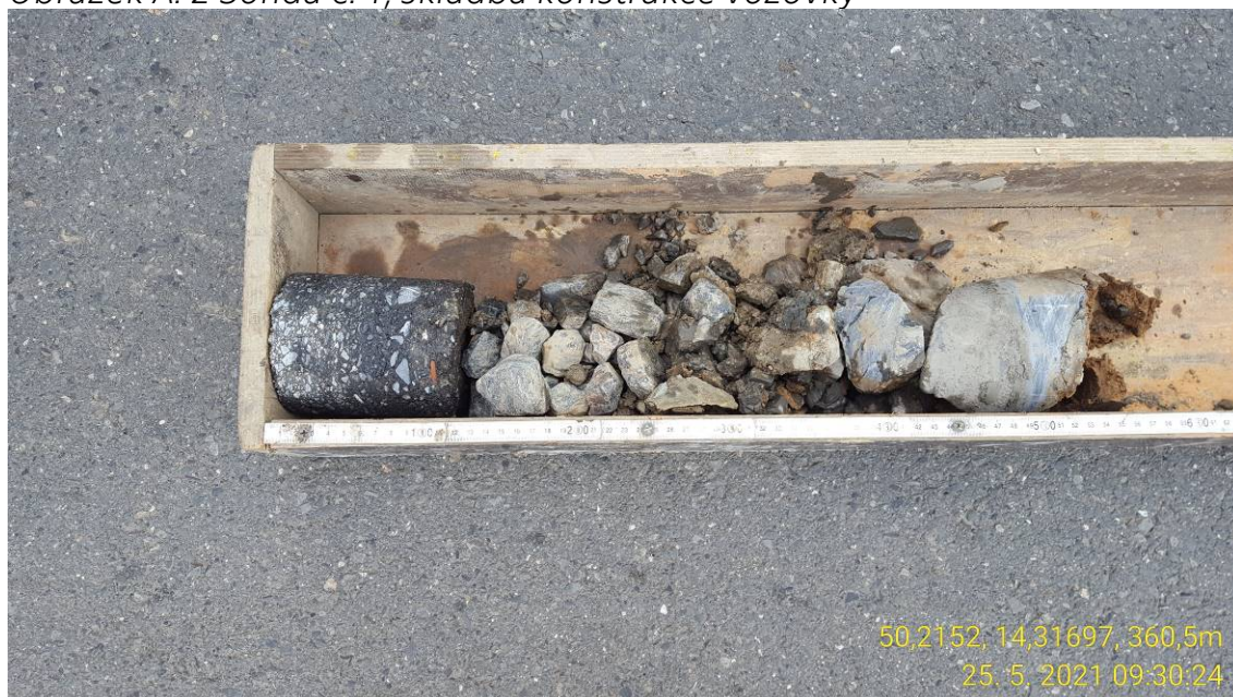
Obrázek A. 2 Sonda č. 1, skladba konstrukce vozovky
